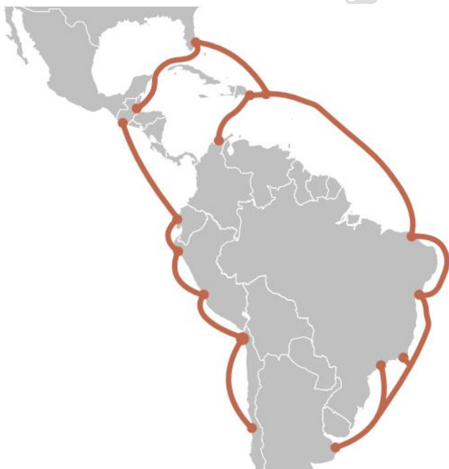
شکل ۱-۱۰: سیستم Sam-1 مسیر یاب‌های ۱۶ شهر در ۱۱ کشور مختلف را با استفاده از بیش از ۱۵ هزار مایل کابل زیردریایی به هم متصل می‌کند.
